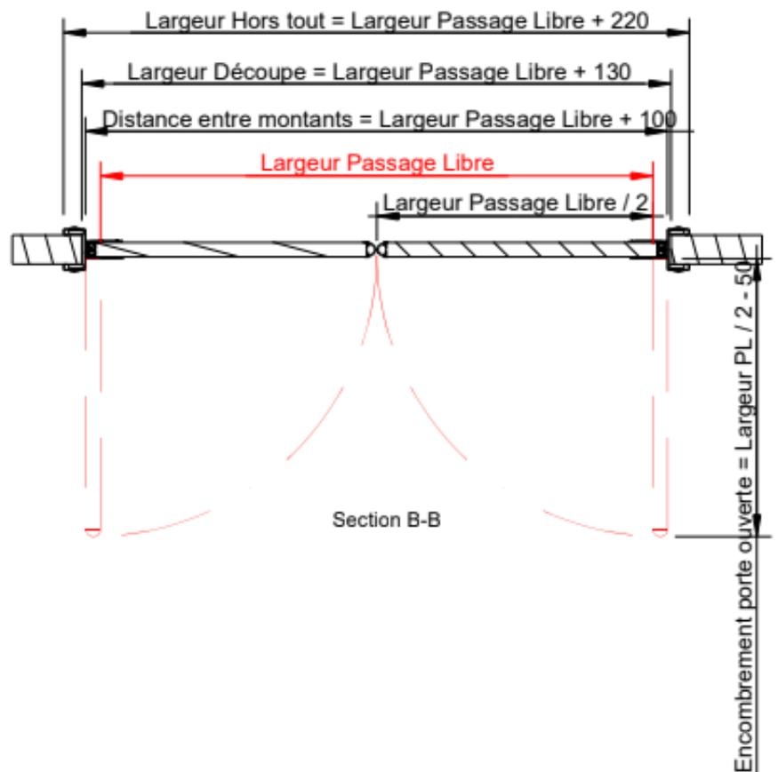
**Porte va et vient semi-isotherme à double vantaux**
